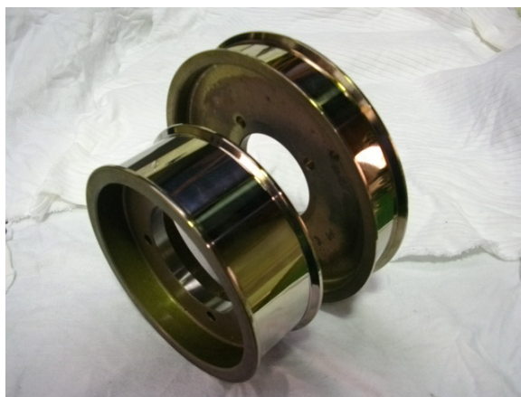
図 2-3-3-4. ガイドローラー（計尺、ターン） (SKD11)
