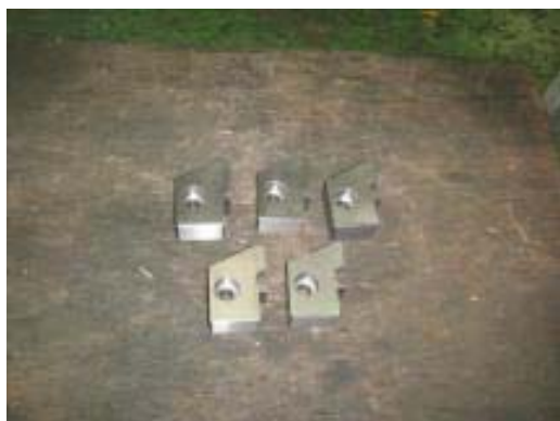
図 2-3-3-2. 鉄筋用切断刃物 (QCM8)
