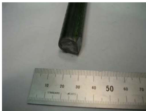
図 2-3-3-3. ストロングフープ材 切断部
