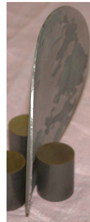
図 2.4 平板の片側浸炭油冷の焼曲り状態 図 2.5 円板(厚さ 1mm)の片側浸炭油冷の焼曲り状態
