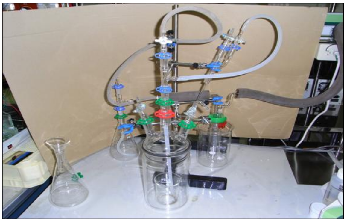
図 1-5 量産用 2 段階真空注入装置
