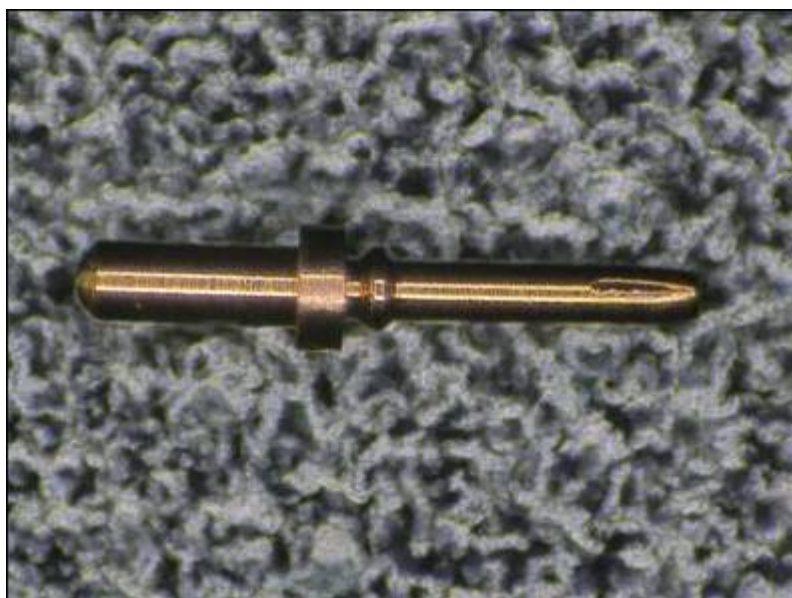
図 3-1 内径 100 μm φ コンタクトプローブ素材 (Be-Cu 材)
