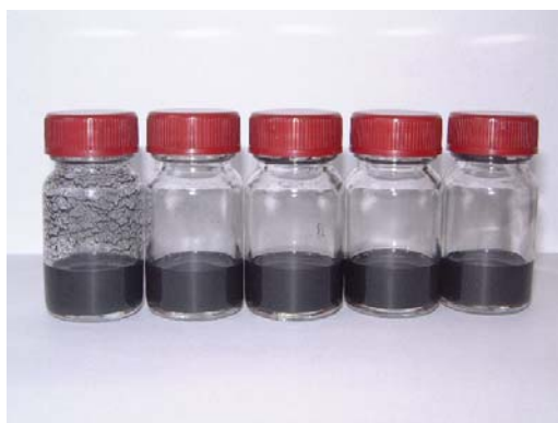
写真1 グラフトポリマーAとCSCNTとのグラフト化反応の経時変化 左より反応開始前⇒反応終了後への経時変化状態
