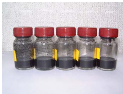
写真3 非グラフト化CNTの分散反応の経時変化 左より反応開始前⇒反応終了後への経時変化状態
