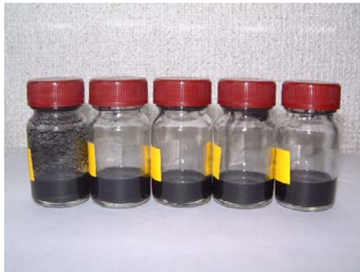
写真2 グラフトポリマーCとCSCNTとのグラフト化反応の経時変化 左より反応開始前⇒反応終了後への経時変化状態
