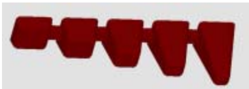
焼成(通気)度用中子の三次元モデル
