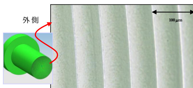
図7-2-1：フレネルレンズの顕微鏡写真
