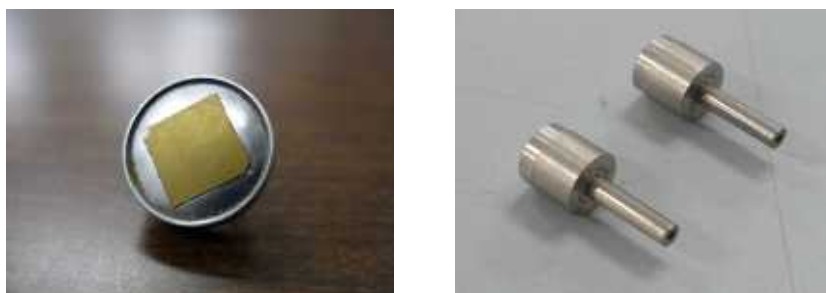
図 15 ダイヤフラム型マイクロポンプおよびマイクロバルブ
