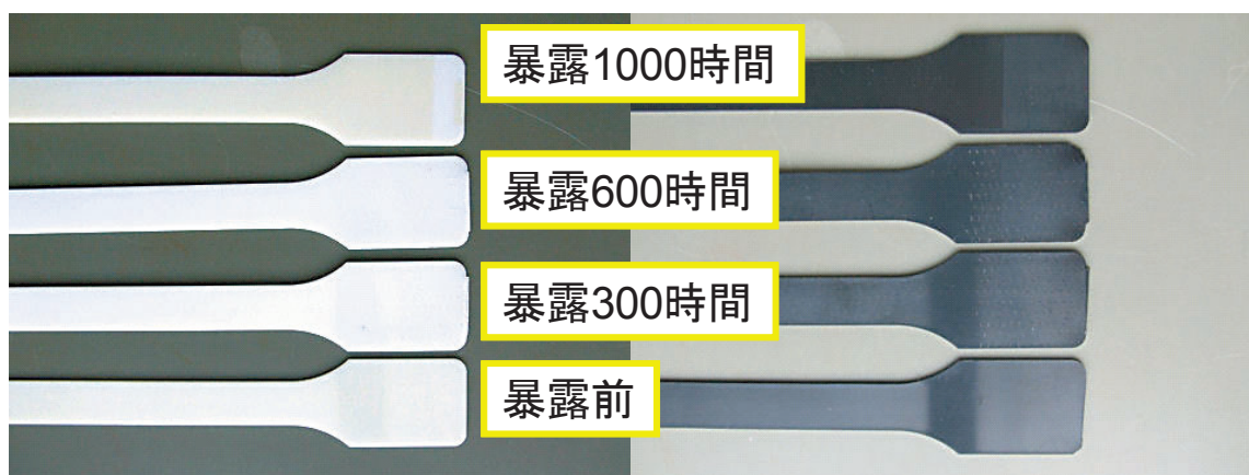
【図 1 1】 暴露試験片の外観
