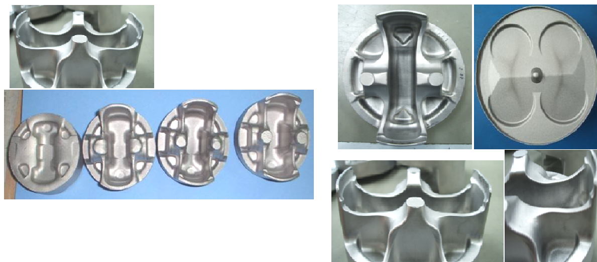
図③-1-6 イジワル試験を実施した 708 ピストンの外観と段打ち結果
