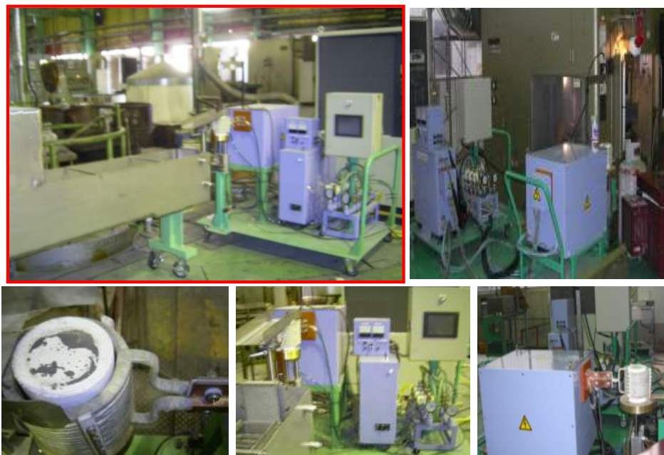
図②-1-8 可塑化処理の効果増強と作業効率化のため導入した高周波加熱装置
