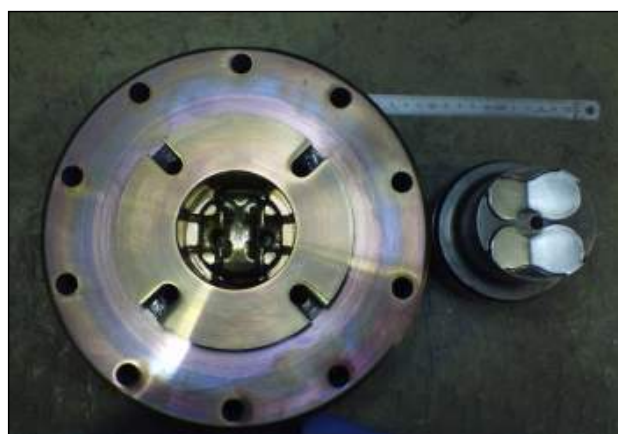
図③-1-5 試作に使用した 708 ピストンとロアーブラケット金型
