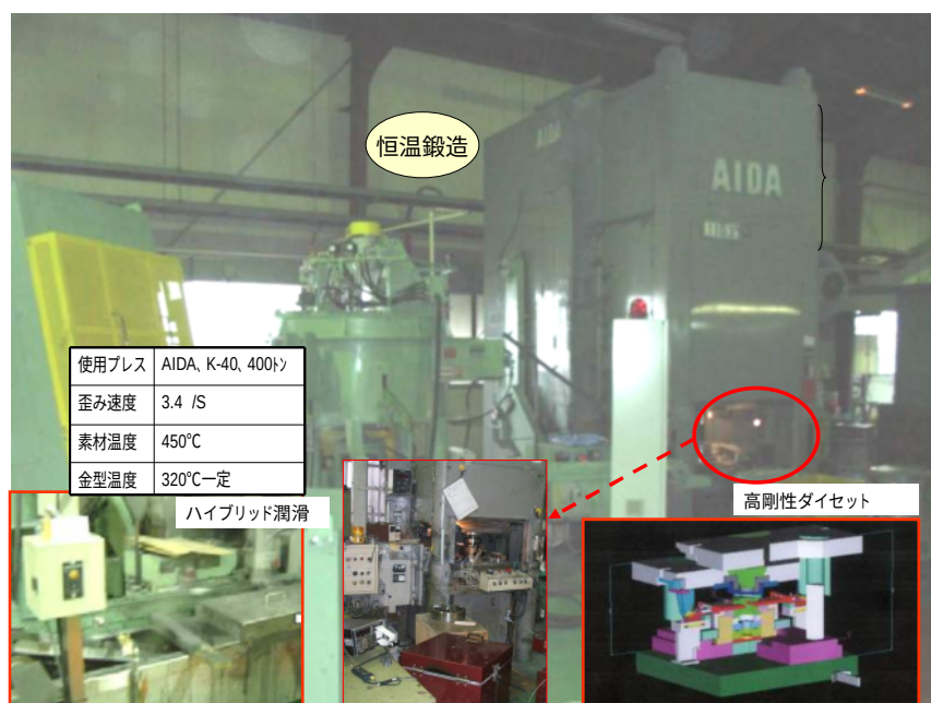
図③-1-2 ピストン鍛造に使用した金型
