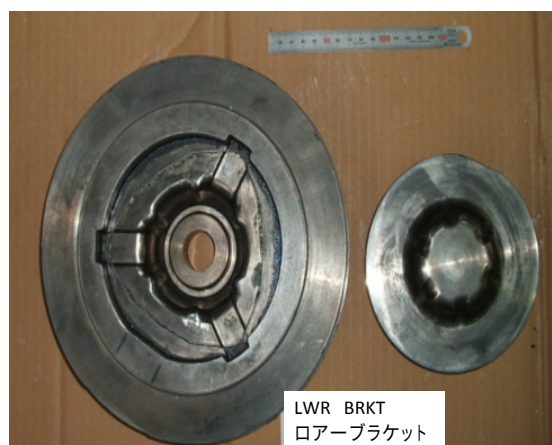
図③-1-5 試作に使用した 708 ピストンとロアーブラケット金型
