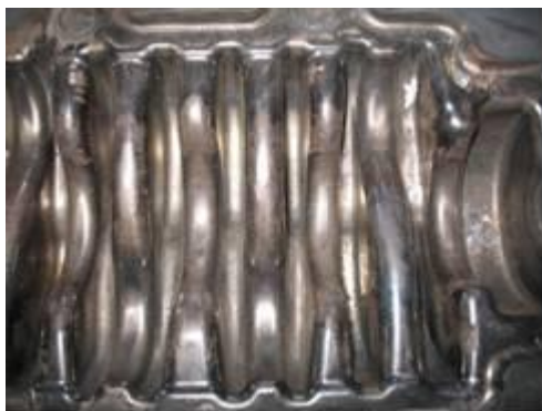
写真8 使用後の計測用金型
