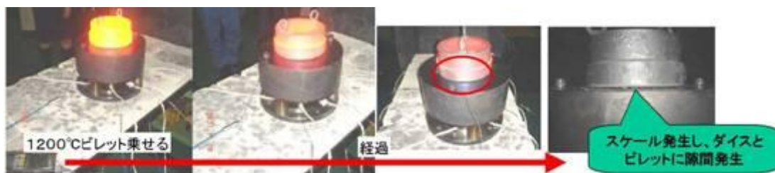
写真 10 簡易試験の様子
