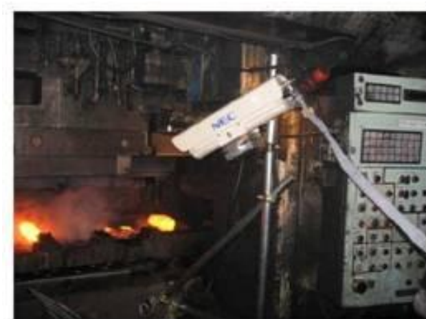
写真2 サーモビューア計測風景
