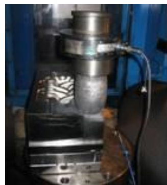
写真6 アルミ材据え込みによる事前確認試験
