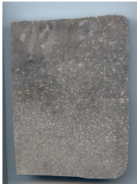
図4 鑄物組織に及ぼす超音波の影響
