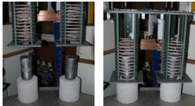
図12 ビレット高周波誘導加熱装置
