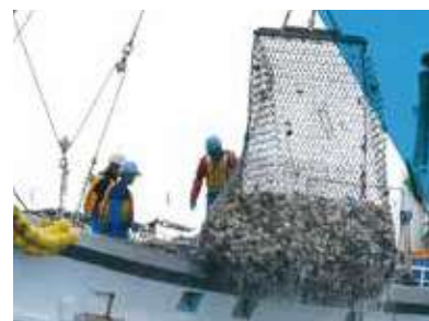
ホタテ桁曳網漁業用「ホタテリング網」
