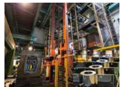
マシニングセンターと自動倉庫
