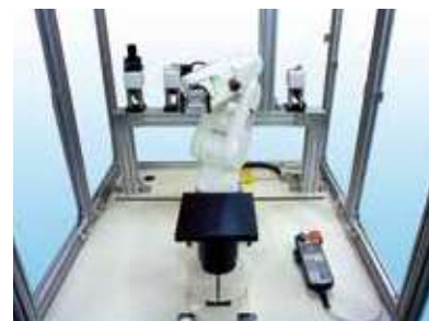
全自動の磁界分布評価装置
