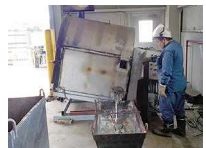
亜鉛カスの回収装置（同社開発）
