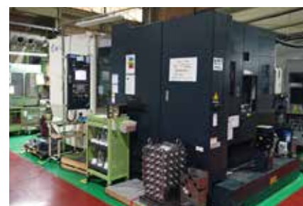
マシニングセンターと治具での高効率生産
