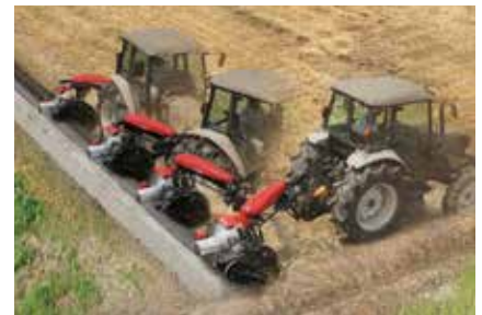
オートあぜ塗り機（ガイア）作業
