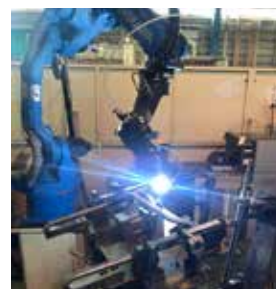
ロボットによる溶接工程
