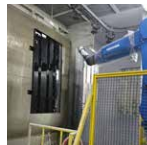
熟練職人のスキルを記憶した塗装ロボット
