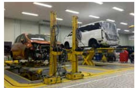
イタリア製ジグ式フレーム修正機
