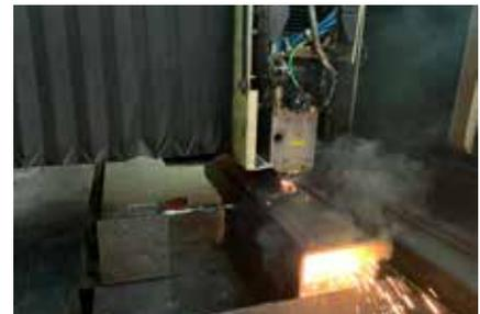
レーザー加工機でのパイプ穴あけ加工
