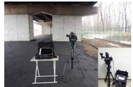
超高精細画像を用いた点検システム
