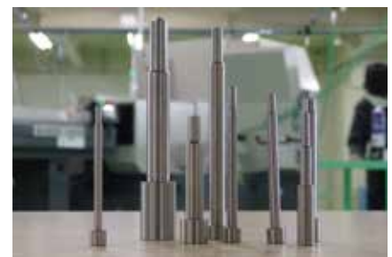
高硬度材料を切削加工した鋳抜きピン
