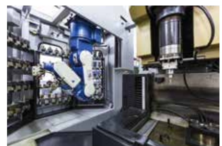
ロボットアームつき型彫放電加工機
