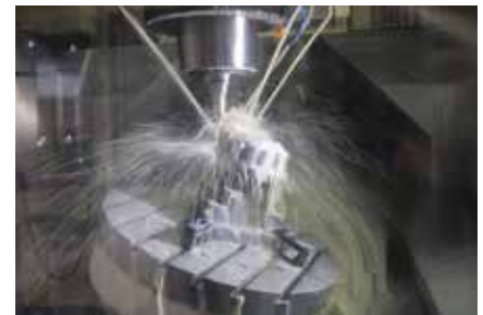
トランスミッション用金型の高精度加工
