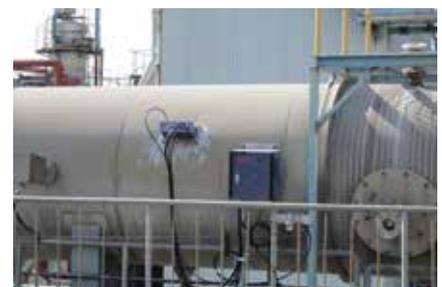
自社製品の非吸引光散乱式ダスト濃度計
