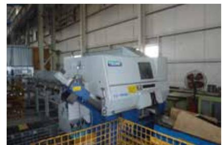
仕上り面のきれいな高速丸鋸切断機
