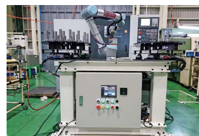
新設備導入（協働ロボット）
