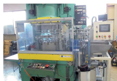
導入したプレス自動供給装置
