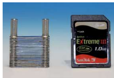
産学連携で開発したマイクロ熱交換器
