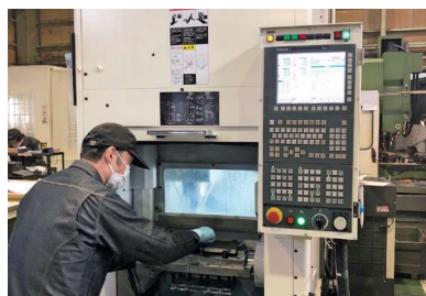
同社の主力設備 量産型高精度立型マシニングセンター
