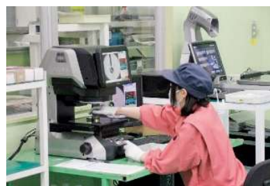
画像寸法測定器による合否判定
