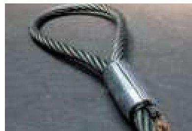
プレス機によりロープとアルミ管を圧縮
