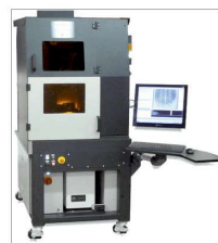
フェムト秒レーザー加工機 【特徴】超短パルスレーザー(1000兆分の1)の為、極めて熱影響の少ない加工が実現できる。よって、融点が非常に低い材料に有効。(加工径 20μm~)
