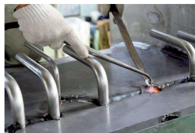
「鉛工職人」による鉛の溶接技術
