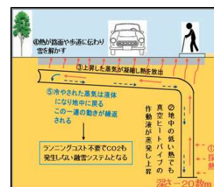
地中熱真空ヒートパイプ融雪設備
