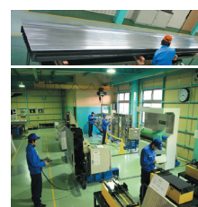
大型ジャバラ(上)と試験機による品質管理(下)
