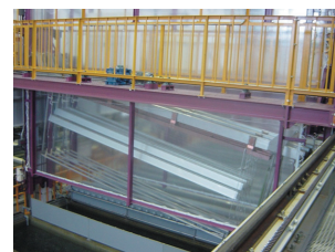
長尺材に対応可能な全自動アルマイトライン
