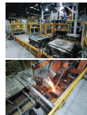
上：自動造型機 下：自動注湯機
