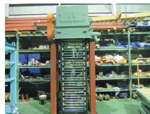
冷間圧延油のろ過装置（マグネットセパレーター）
