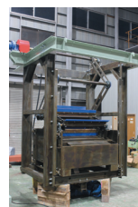
冷間圧延油のろ過装置（フローティングスキマー）
