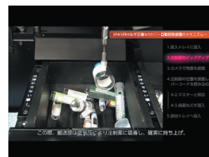
「SPASER内のピッキング・画像処理工程の様子」
