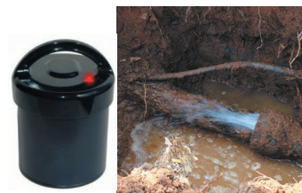
開発製品と発見漏水
