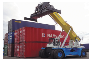
リーチスタッカーを配備、自社内でコンテナと車両のオンオフが可能
