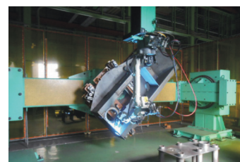
溶接ロボット
