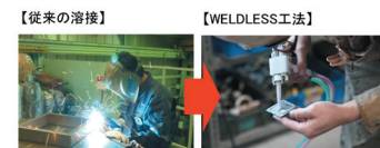
溶接不要な「WELDLESS 工法」
