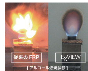
アルコール燃焼試験の比較
