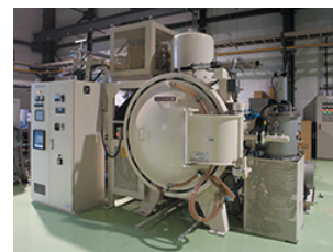
ダイス鋼、ハイス鋼の熱処理設備
