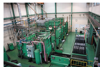
自動化された熱処理生産ライン
