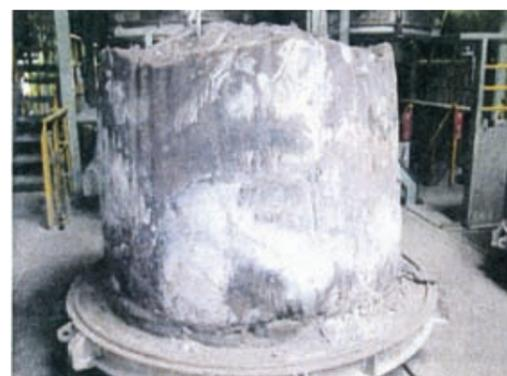
PSA方式窒化珪素鉄の外観
