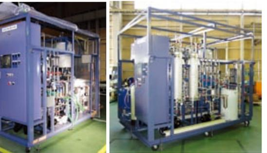
資源回収装置(左図:分離型、右図:一体型)
