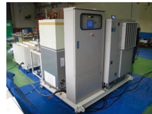
PSA-VOC回収プロトタイプ機外観
