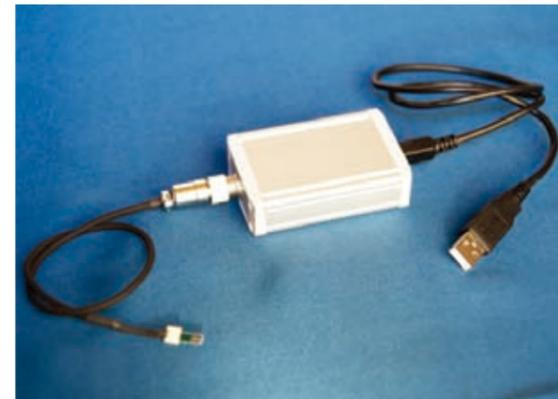
USB接続機能付き電気化学測定器
