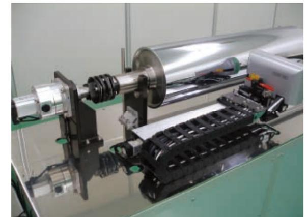
微小欠陥自動検出装置「ミラーマイクロ・P」
