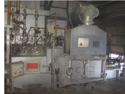
酸化物発生を軽減した集中溶解炉
