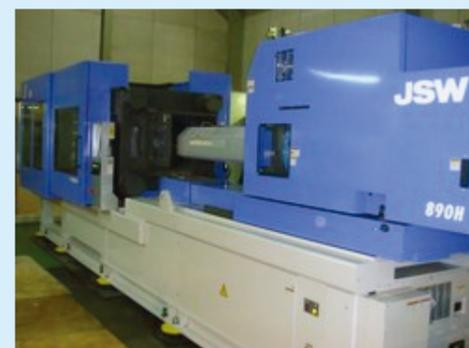
350t 電動射出成型機
