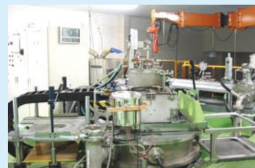
HPG 貴金属粉末製造装置
