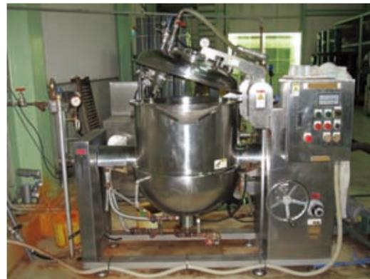
熱水加熱処理に用いる小型蒸練機
