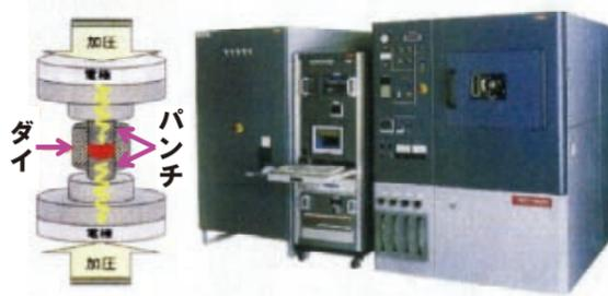
SPSによる粉末焼結方法(左)とSPS装置(右)
