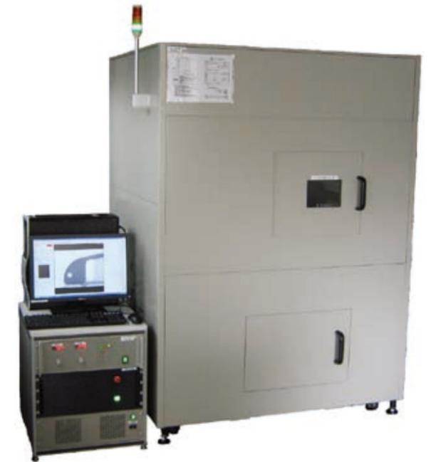
自動内部欠陥検査装置
