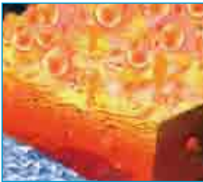
基材上で衝突凝固させて、密着・積層しているイメージ図
