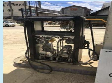
損壊した計量機
